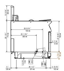
Electrical inlet (power) EQ Equipotential screw
